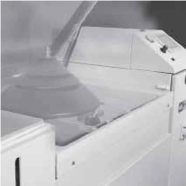
Essai au brouillard salin
